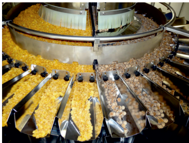
Zwei Komponenten werden gleichzeitig verwogen und abgefüllt
