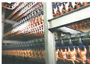
Einblick in den Vorkühlraum. Innerhalb von 90 Minuten werden die Schlachtkörper auf Kerntemperaturen von 2-4 °C gekühlt.
